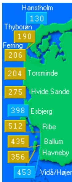
Figur 2: Observeret højvande (cm) langs vestkysten under orkanen den 3. december 1999. Målerne og telefonforbindelserne havde svært ved at klare det hårde vejr - DMI mistede kontakten til vandstandsmålerne i Esbjerg og Vidå/Højer netop som orkanen var på sit højeste. Heldigvis fortsatte Kystinspektoratets (KIs) målere i samme havne med at virke, og restistreringer fra disse målere er anvendt her. KIs måler i Ribe blev sat ud af spillet kl. 17 15 . I Ribe har det virkelige maksimum derfor muligvis været endnu højere end de anførte 5.12m. Højden af diget i Ribe er 7m (kilde: Kystinspektoratet).
